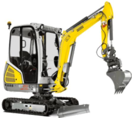
Excavación eficiente gracias al accionamiento potente con tren de rodaje telescópico para espacios muy reducidos y una pala niveladora ajustable para un trabajo seguro.
