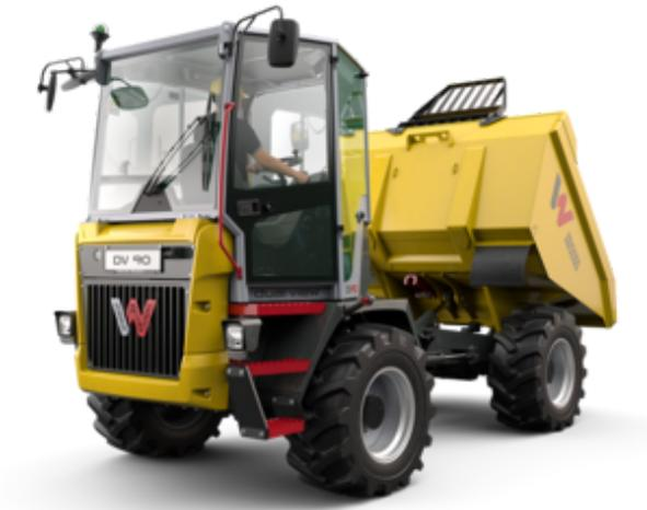
El Dual View DV90 establece nuevos estándares en lo que respecta a la seguridad para el operador y la obra, la flexibilidad y la rentabilidad. El concepto Dual View permite un cambio rápido y cómodo de la posición del asiento gracias a un giro de 180 grados de la consola de mando y del asiento. De esta manera, el usuario siempre tendrá perfecta visibilidad en la dirección de marcha durante el transporte, la carga y la descarga.
