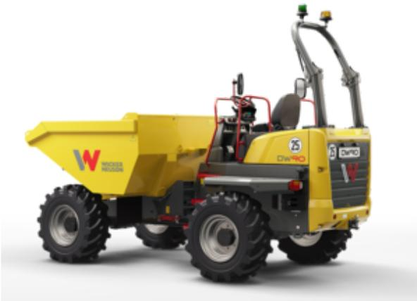
Los terrenos irregulares son los favoritos del dumper sobre ruedas DW90, porque aquí es donde puede desplegar todas sus ventajas: tracción hidrostática a las cuatro ruedas con el modo ECO, excelente movilidad todoterreno, freno de estacionamiento accionado por resorte sin desgaste y cabina con rejilla protectora opcional para la caja de volteo.
